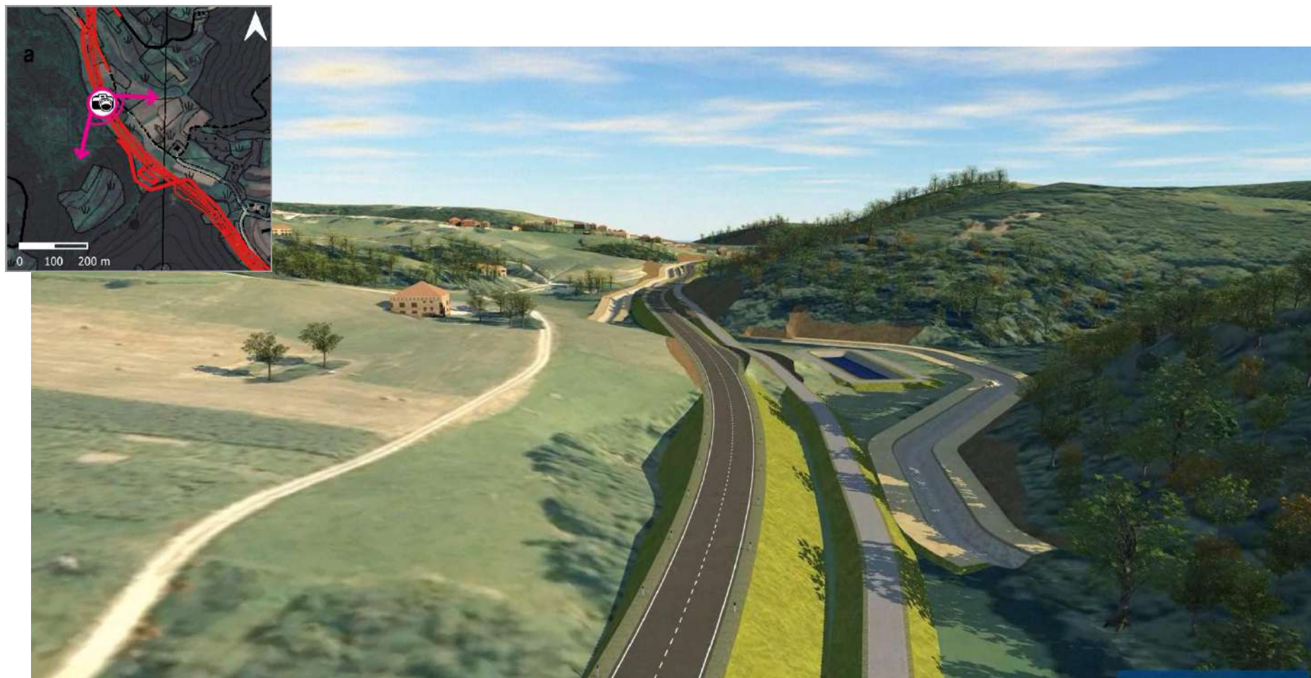
Sl. 4.1-11. Točka E. Vizualizacija planiranog zahvata – pogled iz zraka na početak izmještanja potoka Jastrebitica (km 3+200,00)
